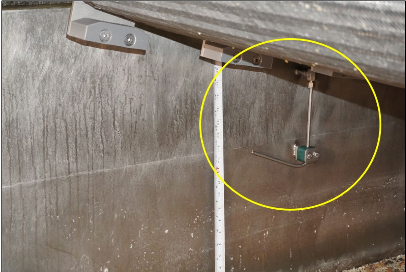
Figura 10. Medidor de tipo burbujeo de congelador por inmersión, como se encontró durante el examen del congelador posterior al incidente. Tal como está diseñado, el medidor debe apuntar directamente hacia abajo. (Crédito: CSB)
