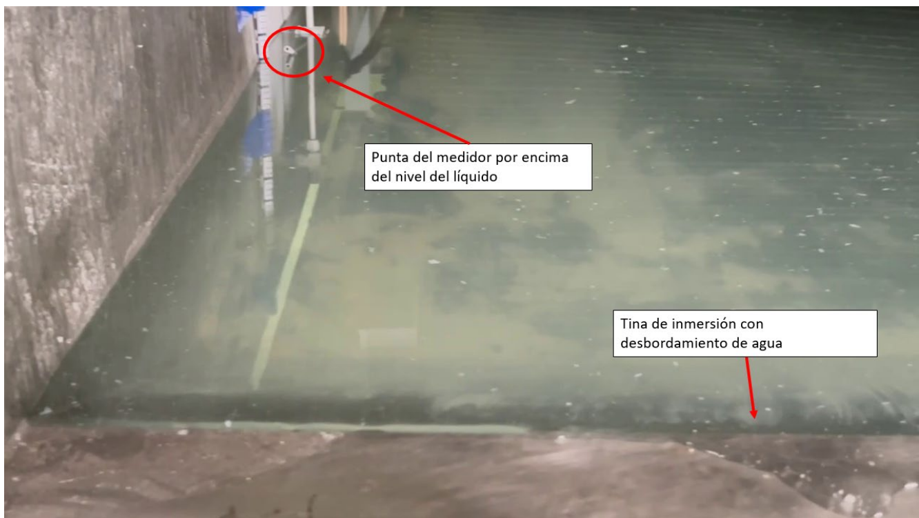
Figura 13. Agua que se desborda de la tina del congelador por inmersión durante la prueba de desbordamiento posterior al incidente. (Crédito: CSB)
