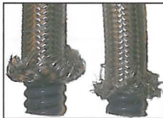
Mangueras Hastelloy (izquierda) y de acero inoxidable parecen idénticas.
